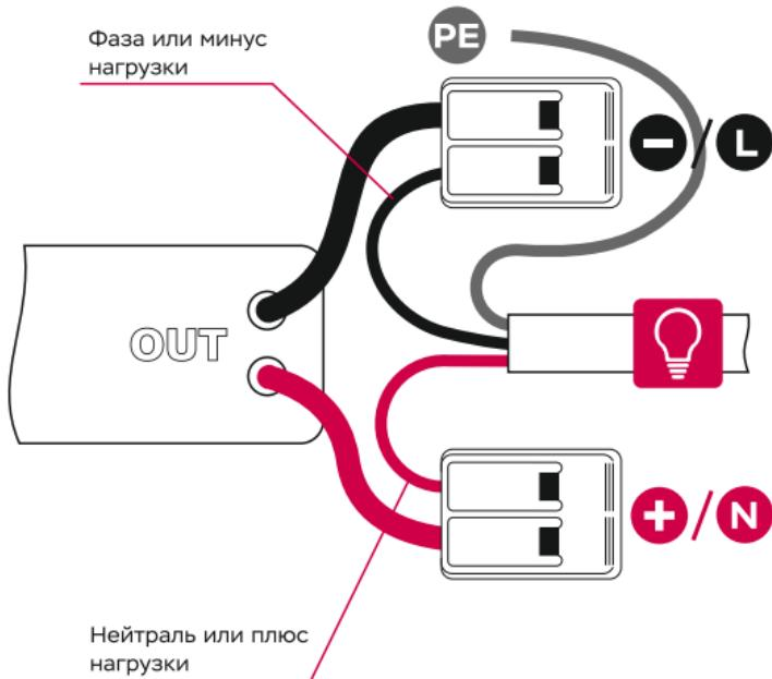
**Вариант 2.** Подключение к светильнику, у которого есть свои клеммы.
